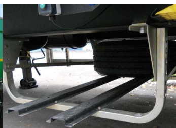
Корзина для 2-х запасных колес расположена в центральной части, каркас оцинкован, установлен умывальник для рук
