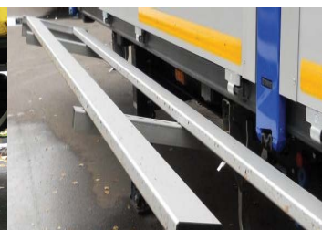
Откидная боковая защита из алюминиевых профилей производства BPW, противооткатные упоры изготовлены из пластика и расположены в удобном для водителя месте
