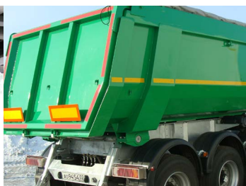
Платформа с косыми передним и задним бортами может быть изготовлена из высокопрочной стали
